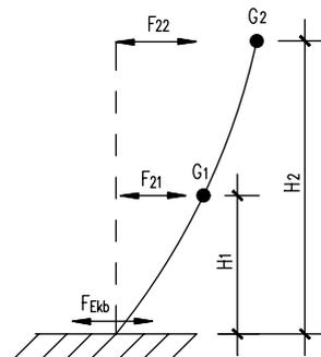
图 A.1.1 结构水平地震作用计算简图
